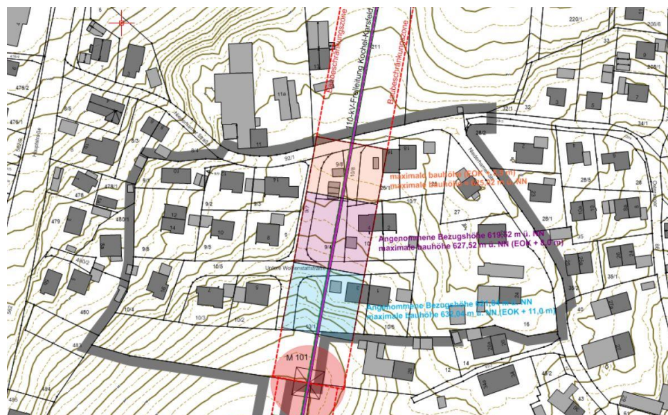
Abb. 6: Plangebiet mit Leitungsverlauf der 110 kV Freileitung der Bayernwerk Netz GmbH, ohne Maßstab, Quelle: Bayerische Vermessungsverwaltung, Stand 04/2020, eigene Darstellung, Angaben Bayernwerk Netz GmbH mit Stand 2018
